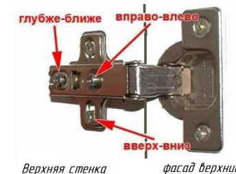
Рис.3 Установка вкладной петли
